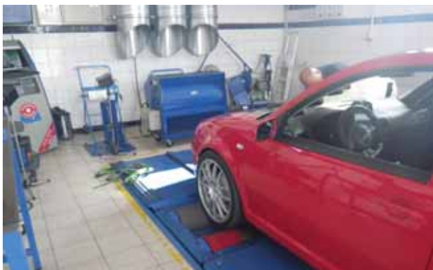
Ispitivanje snage motora Centar za vozila Hrvatske
